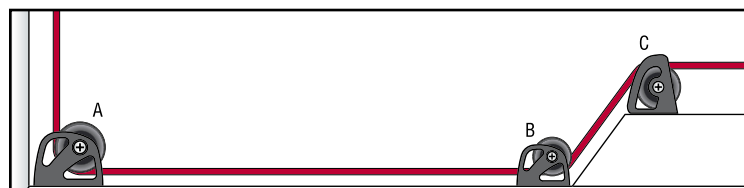
4. I bozzelli speciali "Over the Top" sono necessari quando le manovre devono fare percorsi non usuali come un angolo esterno di una cabina o della mastra.
